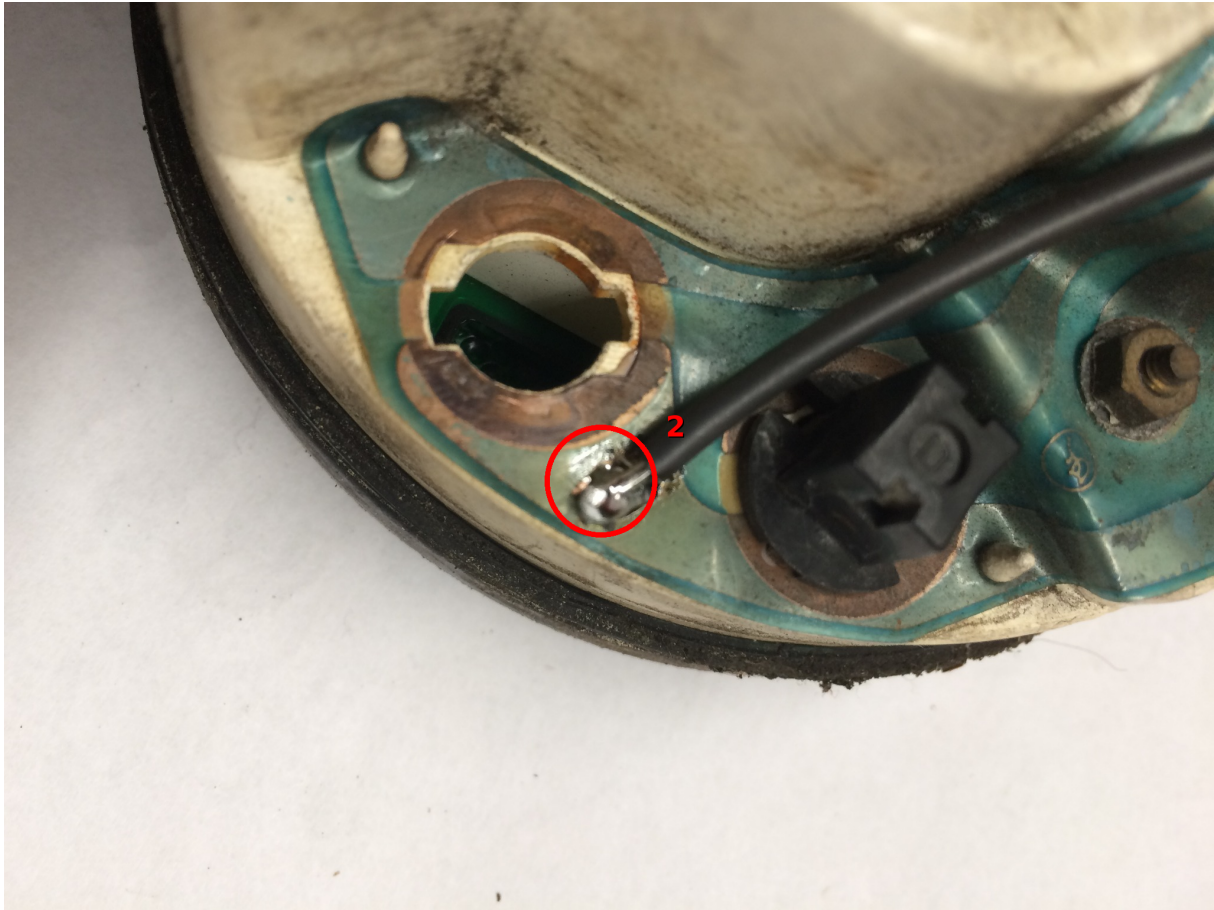
Abbildung: 2 - Nach dem Trennen den Lampenkontakt verzinnen und Massekabel anlöten.
