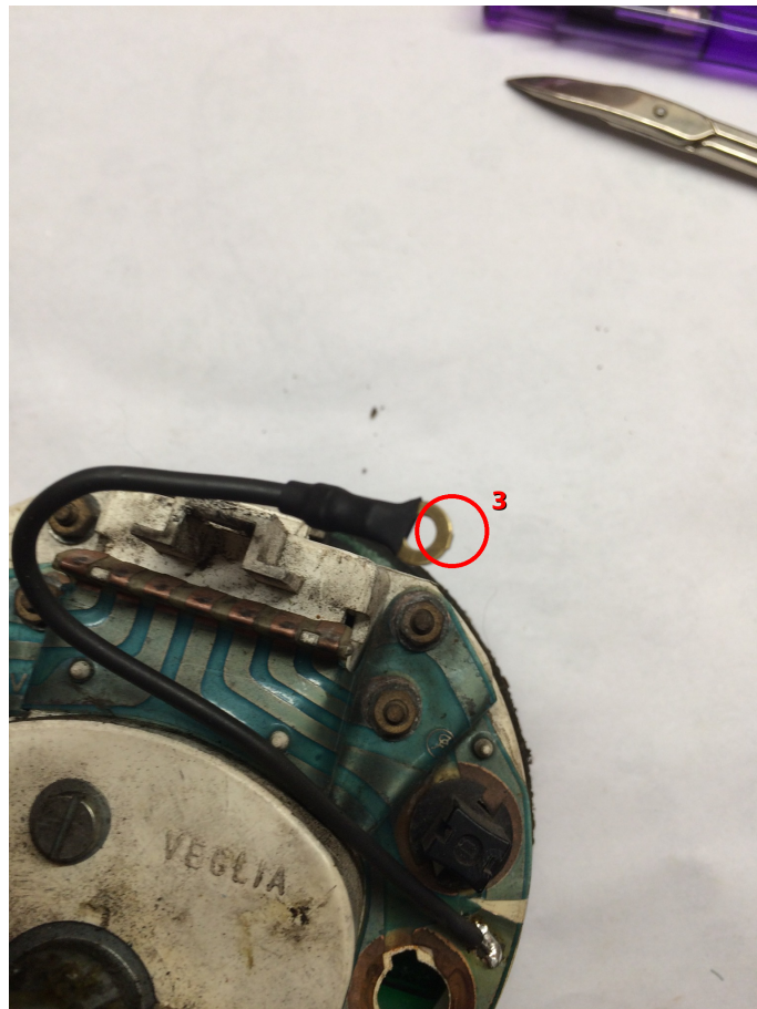
Abbildung: 3 – Beispiel: Massekabel mit Ringkabelschuh an einen Massepunkt/Schraube bzw. direkt an den Rahmen führen.
