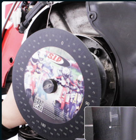
10: Polrad gegen den Uhrzeigersinn drehen bis Markierung „T“ von Zündgrundplatte mit Markierung „TIMING“ von Polrad exakt übereinstimmt. Gradzahl ablesen. (hier im Beispiel 23°)
