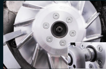
12: Haltewerkzeug montieren. Polrad mit Mutter und Sternscheibe auf Kurbelwelle montieren. Anzugsmoment 45-60 Nm. [SIP Art.-Nr. siehe Seiten 18 & 19]
