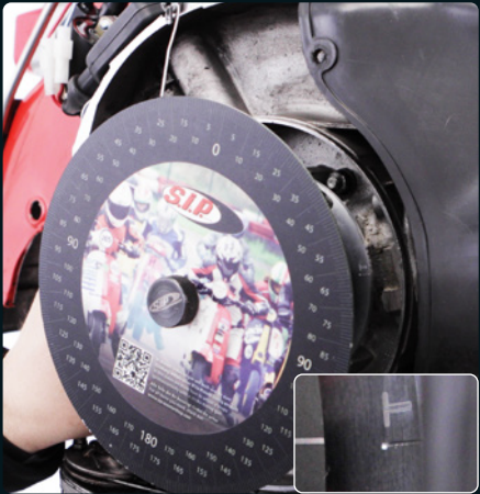
10: Ruotare il Volano in senso antiorario finché la marcatura "T" della piastra corrisponda esattamente alla marcatura "TIMING" del Volano. vedi i gradi (Qui nell'esempio 23°)
