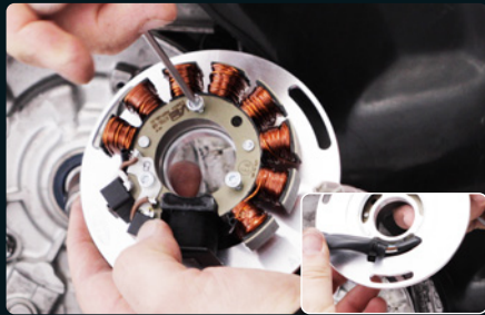
01: Zündgrundplatte montieren. Auf Kabelausgang hinten achten. Schrauben mit Loctite Schraubensicherung montieren. [SIP Art.-Nr. siehe Seiten 18 & 19]
