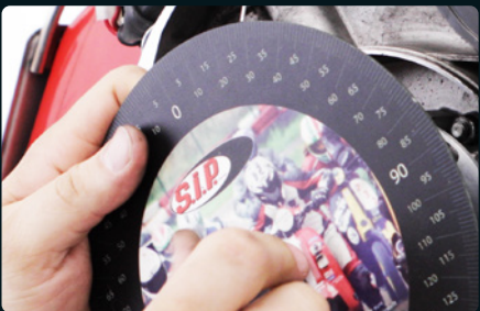
06: Montare il disco graduato e l'indicatore [SIP Art.n° 83002300]. Ruotare il Volano in senso orario, contro lo blocca pistone.
