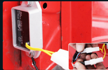
14: Spannungsregler/Gleichrichter montieren. Leitungen mit beiliegendem Stecker verbinden. 12V Leuchtmittel nicht vergessen! Zündung zur Kontrolle abblitzen!
