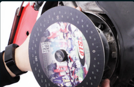
08: Ruotare attentamente il Volano in senso antiorario contro lo stopper del pistone. (Qui nell'esempio 86° sul disco graduato)
