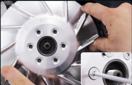
11: Allineare la ventola sul volano. Inserire le viti in dotazione con loctite. Momento di serraggio 12-14 Nm. (numero d'articolo SIP vedi la pagina 18 e 19)
