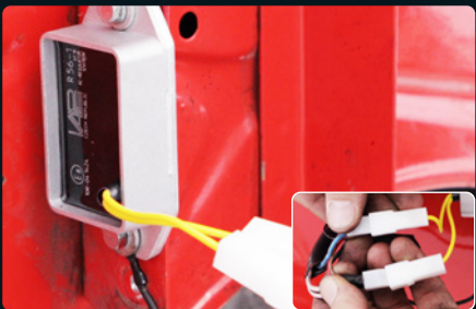
14: Montare il regolatore di tensione/il raddrizzatore. Collegare il cablaggio con la spina in dotazione. Non dimenticare le lampadine a 12V! Controllare Accensione!
