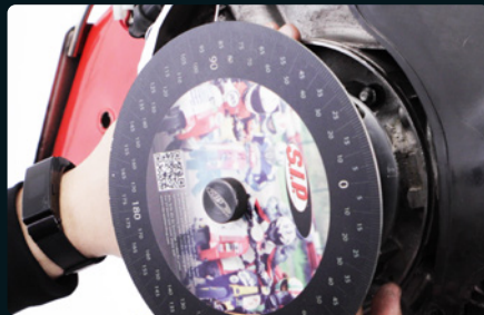
08: Polrad gegen den Uhrzeigersinn vorsichtig gegen Kolbenstopper drehen. (hier im Beispiel 86° auf Gradscheibe)
