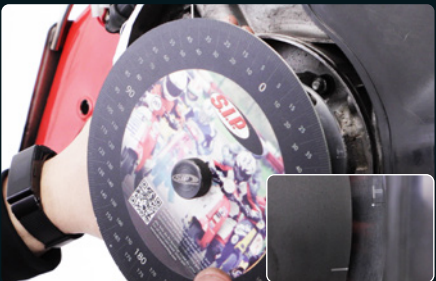
09: Per la rilevazione del punto morto superiore dimezzare il risultato di misurazione. Rimuovere lo stopper del pistone. Ruotare il volano esattamente sul valore rilevato. (Qui nell'esempio 43°)
