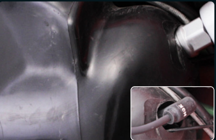
13: Inserire la candela. Se necessario montare una pipetta candela. (numero d'articolo SIP vedi la pagina 18 e 19)
