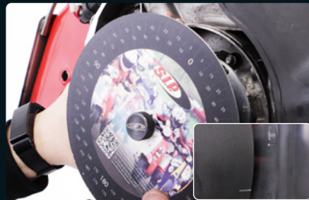
09: Zur Ermittlung des oberen Totpunktes, Messergebnis halbieren. Kolbenstopper entfernen. Polrad exakt auf ermittelten Wert drehen. (hier im Beispiel 43°)
