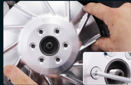
11: Lüfterkranz auf Polrad ausrichten. Beiliegende Schrauben mit Loctite einsetzen. Anzugsmoment 12-14 Nm. [SIP Art.-Nr. siehe Seiten 18 & 19]
