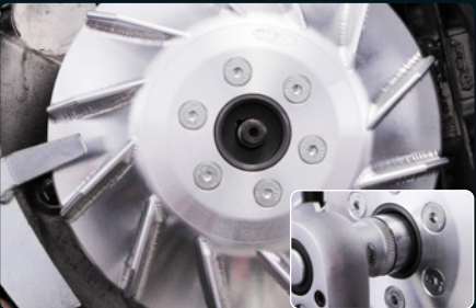
12: Montare attrezzo di serraggio. Montare la ventola con il dado e la rondella a stella sull'albero motore. Momento di serraggio 45-60 Nm. (numero d'articolo SIP vedi la pagina 18 e 19)
