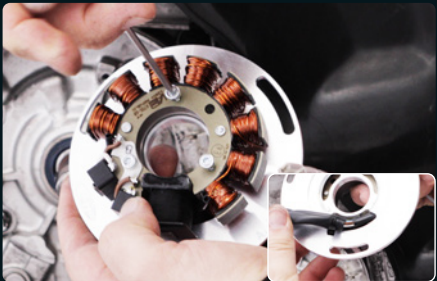
01: Montare la piastra di accensione. Attenzione all'uscita posteriore del cavo! Montare le viti con il ferma viti loctite. numero d'articolo SIP vedi la pagina 18 e 19
