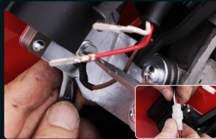
03: Zündspule montieren. Passende Halterung wählen. Kabelstecker montieren und verbinden. [SIP Art.-Nr. siehe Seiten 18 & 19]
