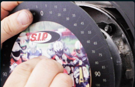
07: Posizionare il disco graduato in questa posizione del Volano esattamente a 0°. Non girare il Volano!
