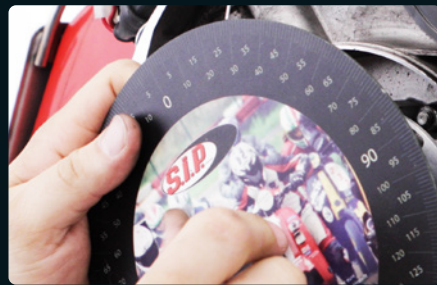
06: Gradscheibe und Zeiger [SIP Art.-Nr. 83002300] montieren. Polrad im Uhrzeigersinn gegen Kolbenstopper drehen.
