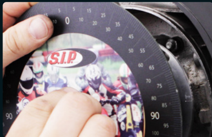
07: Gradscheibe in dieser Polrad-Position exakt auf 0° stellen. Polrad dabei nicht verdrehen.
